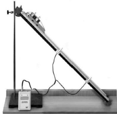
Для проведения измерений используйте штатив, направляющую, электронный секундомер с датчиками, брусок, линейку и транспортир.
