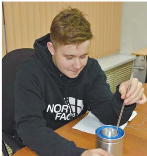
**Рис. 4.** Измерение температуры во внутреннем стакане калориметра
