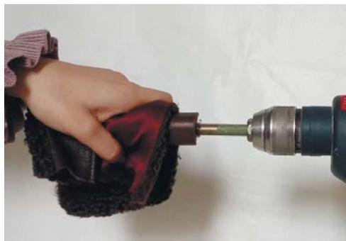
**Рис. 1.** Демонстрация преобразования механической энергии во внутреннюю
