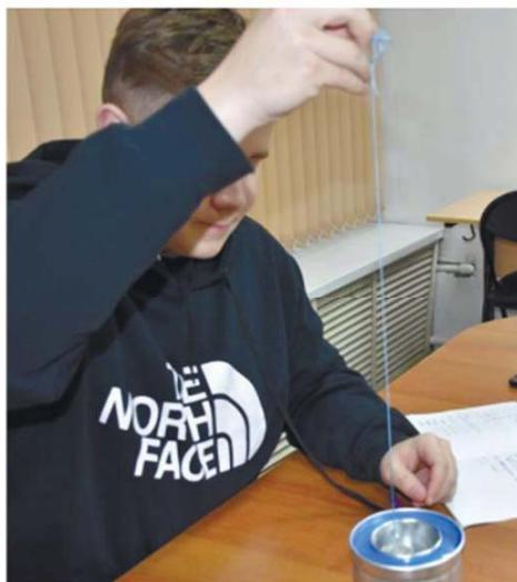
**Рис. 3.** Погружение в стакан калориметра нагретого цилиндра
