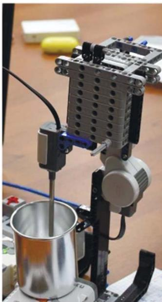
**Рис. 6.** Механизм погружения датчика температуры в стакан калориметра
