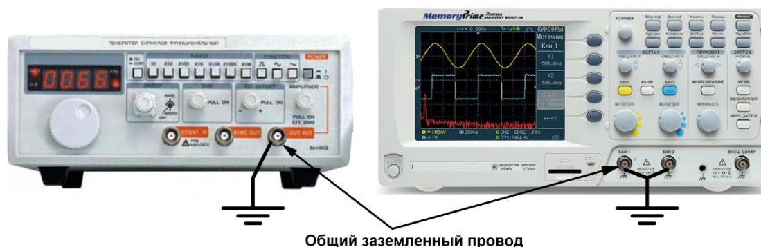
Рисунок 1. Передние панели современного генератора и цифрового осциллографа
