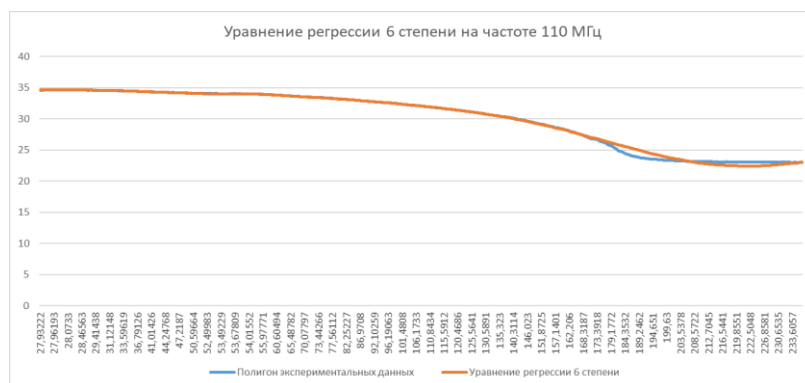
Рисунок 7. Результаты сглаживания экспериментальных данных уравнением регрессии 6 степени на частоте 110 МГц
