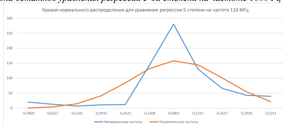
Рисунок 10. Сравнение кривой нормального распределения и эмпирического полигона остатков уравнения регрессии 5-ой степени на частоте 110 МГц
