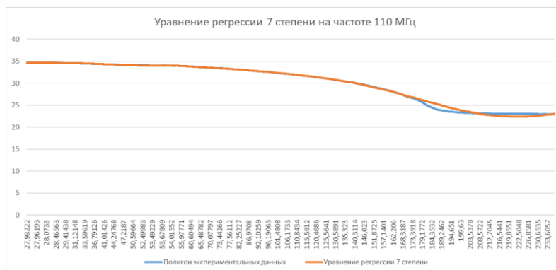
Рисунок 6. Результаты сглаживания экспериментальных данных уравнением регрессии 7 степени на частоте 110 МГц
