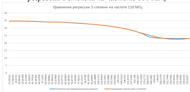
Рисунок 8. Результаты сглаживания экспериментальных данных уравнением регрессии 5 степени на частоте 110 МГц
