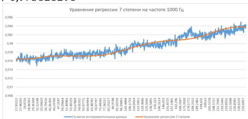
Рисунок 3. Результаты приближения экспериментальных данных уравнением регрессии 7 степени на частоте 1000 Гц
